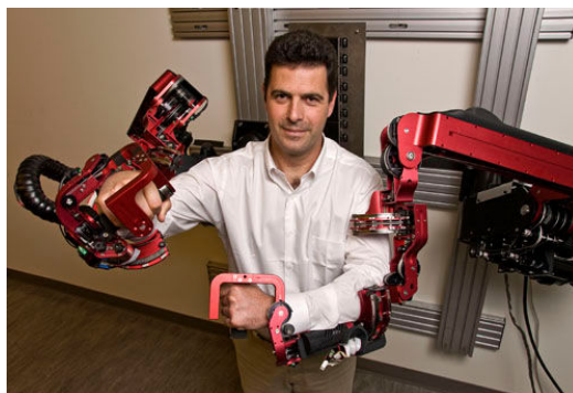
Figura 1.1: Exoesqueleto de membro superior com 7 DoF para reabilitação fisioterápica. (PERRY; ROSEN; BURNS, 2007)
