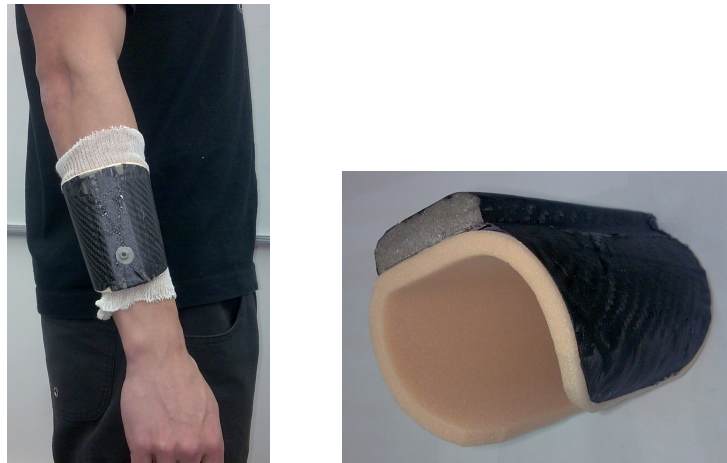
Figura 7.2: Fixações de carbono desenvolvidas no Laboratório de Biomecatrônica em parceria com a empresa Alltec. À esquerda, um usuário vestindo a fixação de antebraço. À direita, um zoom da mesma.
