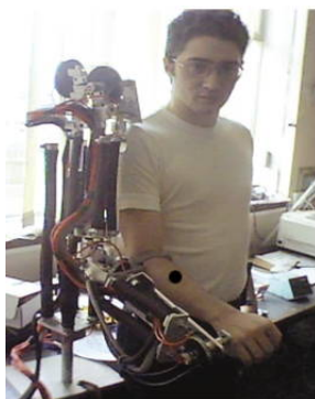
Figura 1.3: Exoesqueleto de membro superior com 7 DoF de baixo custo com atuadores pneumáticos. (TSAGARAKIS; CALDWELL, 2003)
