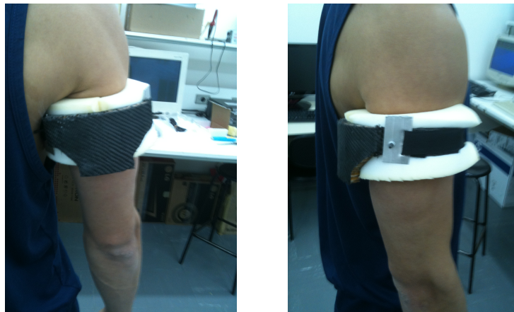
Figura 5.2: Prova conceitual da interface física entre homem e robô fabricada em fibra de carbono para minimizar a massa do exoesqueleto sem comprometer suas características estruturais.
