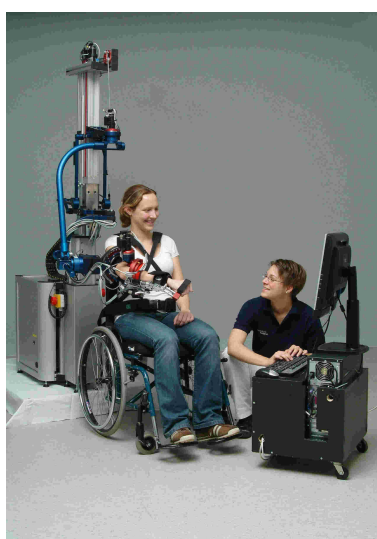
Figura 1.2: Exoesqueleto de membro superior com 4 DoF para utilização em clínicas de reabilitação. (MIHELJ; NEF; RIENER, 2007)
